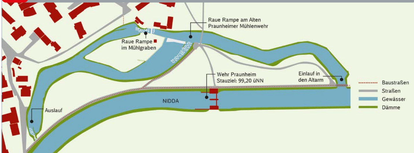
Schematische Darstellung der Renaturierungsmaßnahme Praunheimer Wehr
